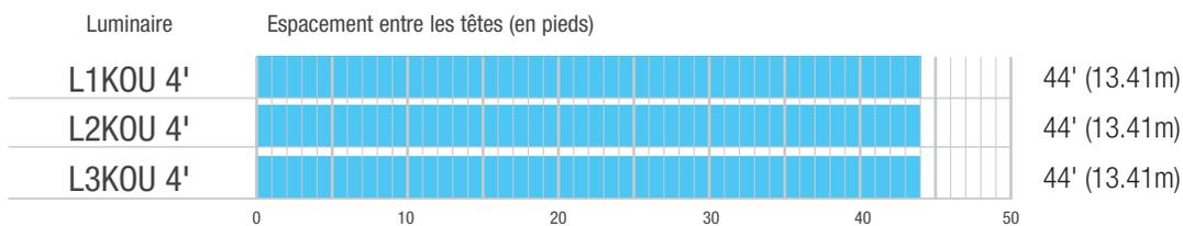
Espacement moyen de 1 luminaire sur 4 normalement allumé dans le chemin de sortie à des hauteurs de montage de 8, 10 ou 12 pieds
