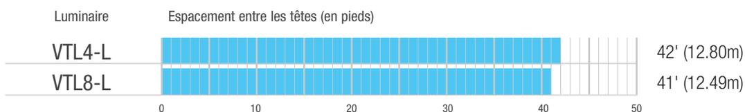
Espacement moyen de 1 luminaire sur 4 normalement allumé dans le chemin de sortie à des hauteurs de montage de 8, 10 ou 12 pieds
