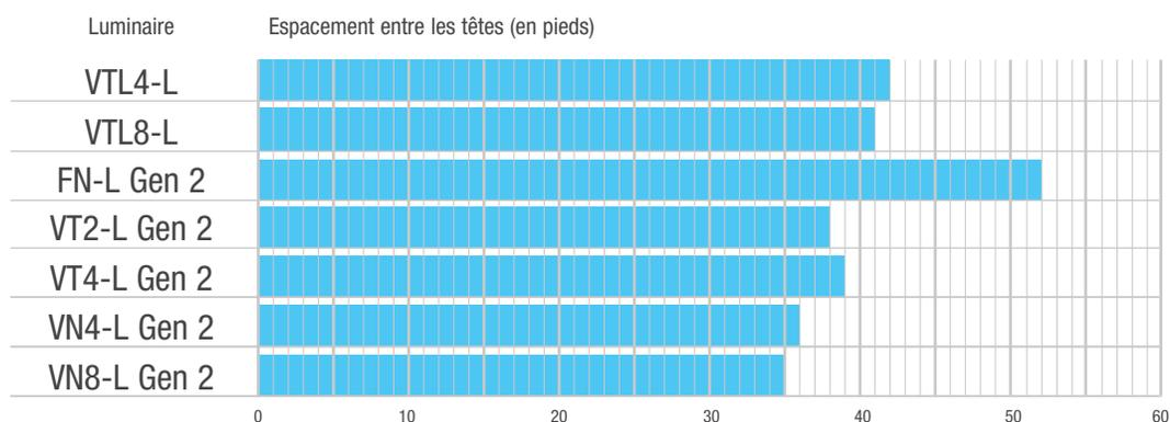
Espacement moyen de 1 luminaire sur 4 normalement allumé dans le chemin de sortie à des hauteurs de montage de 8, 10 ou 12 pieds
