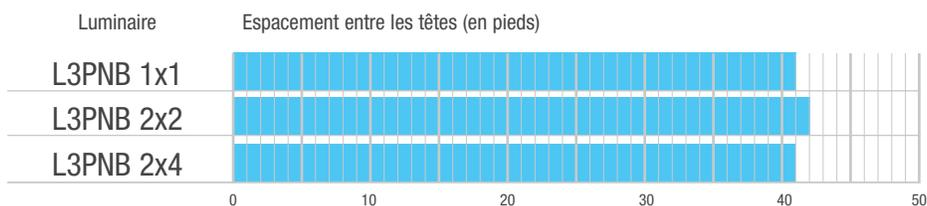
Espacement moyen de 1 luminaire sur 4 normalement allumé dans le chemin de sortie à des hauteurs de montage de 8, 10 ou 12 pieds
