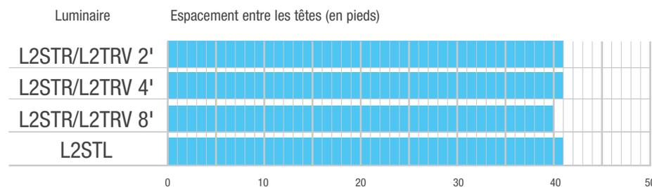
Espacement moyen de 1 luminaire sur 4 normalement allumé dans le chemin de sortie à des hauteurs de montage de 8, 10 ou 12 pieds
