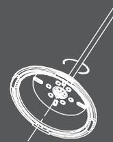
2 - Placez le support de montage au bas de la tige et fixez-le avec l'écrou M10.
