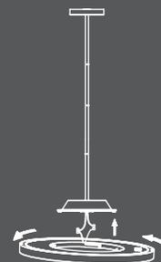
3 - Tourner et verrouiller pour fixer le luminaire sur le support de montage
